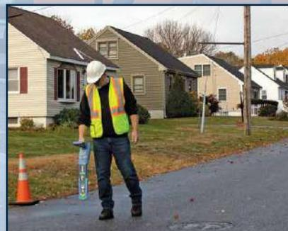
Les défauts d'isolement des câbles sont localisables avec une précision de 10cm à l'aide du mode de recherche 8 kHz Fault Find en utilisant un arceau Radiodetection.
